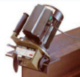
снятие фаски с криволинейных кромок
